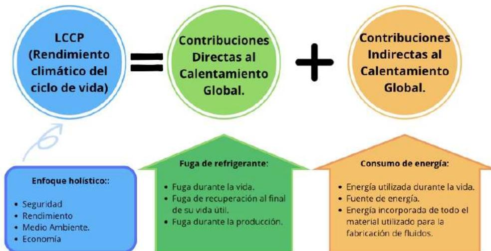
Figura 2. Vista del rendimiento climático del ciclo de vida en base al rendimiento del equipo.
