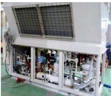
Figura 10. Unidad condensadora con microcanales tal y como se utilizó en el CTS durante los estudios del evaporador de NH3.
